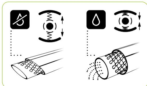
Lorsqu'il n'est pas utilisé, FITT Force est plat et parfaitement rangé sur le dévidoir. Lorsqu'on ouvre le robinet, le tuyau se remplit d'eau et assume sa forme classique ronde : le mécanisme **DYNAMIC TECH** accompagne l'extension du tuyau. Lorsqu'on referme le robinet, le tuyau redevient plat et le mécanisme retourne sur sa position initiale en maintenant FITT Force parfaitement rangé.
