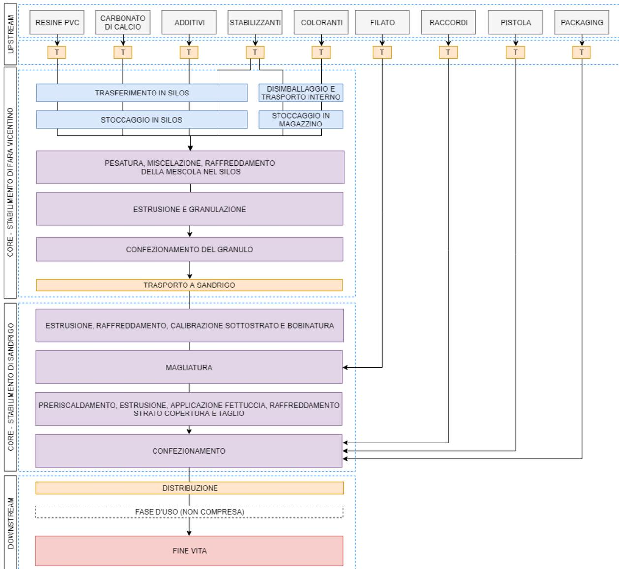
Figura 1 Schema del processo produttivo relativo ai prodotti della famiglia FITT NTS
