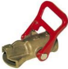
Robinet jet diffuseur mixte DMFB à 3 positions : arrêt – jet diffusé en nappe – jet droit (système de diffusion qui produit une nappe d'eau en forme de tronc de pyramide à section rectangulaire aplatie)
