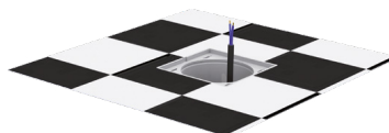
3. Faire ressortir complètement le câble au niveau de la boîte de connexion.
