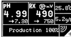
Avec la touche **+**, on se déplace de l'écran d'accueil à la filtration si l'auxiliaire est sélectionné. En appuyant sur la touche **+**, on atteint l'écran d'accueil du spot si l'auxiliaire est sélectionné. Pour se déplacer entre les écrans d'accueil, il faut utiliser les flèches **+** et **-**.
