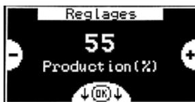
**Remarque :** cet appareil dans sa configuration normale est autonome et régule la puissance en fonction de ses propres mesures. Il est donc recommandé de laisser la puissance à 100% par défaut.
