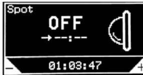
**Remarque** : le mode SPOT désactive l'électrolyse pendant son fonctionnement. L'électrolyse se remet en marche automatiquement une fois que le SPOT est désactivé.
