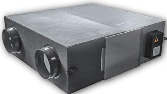
Recuperatore di calore statico con flussi in controcorrente, costituito da fogli piani di carta speciale dotati di apposita sigillatura per mantenere separati i flussi e permeabili al solo vapor acqueo. Scambio termico di tipo "totale" ad elevata efficienza sia sulla temperatura che sull'entalpia.
