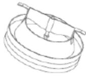
Valvola di immissione/estrazione d'aria adatta per abitazioni, uffici, ecc., dotata di buona capacità di regolazione grazie al disco piatto regolabile manualmente, isolato sulla faccia interna con polietilene espanso sp.10mm.
