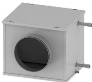
Le unità di pre/post riscaldamento e raffreddamento ad acqua sono costituite da telaio in lamiera zincata ed una batteria di scambio termico composta da tubi di rame ed alette di alluminio. Sono predisposte di flange circolari che facilitano l'installazione al condotto.
