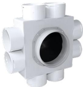
Box di distribuzione SLIM LITTLE isolato esternamente e rivestito internamente con pannello termoacustico. Nr. 1 collare Ø125 o Ø160 con guarnizione e collarini per tubo semirigido tondo
