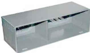
COMBIPL500 è un plenum con mandata e ripresa integrate in un'unica entità. È dotato di una separazione ermetica tra lato di mandata e ripresa per evitare corto circuiti d'aria. Una volta installato, è all'occhio un'unica entità. Completo di due collari selezionabili Ø 125 oppure Ø 160 mm (di tipo ovale) posteriori.
