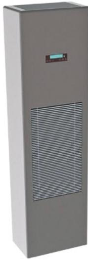
Costruzione adatta ad atmosfere aggressive, completamente in plastica e lamiera trattata appositamente, controllo elettronico a microprocessore, display digitale, classe di impermeabilità IP22, bassa rumorosità, consumi ridotti, ventilatore a doppia velocità, possibilità di brevi canalizzazioni.
