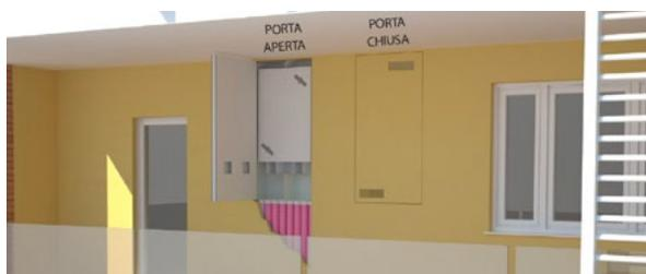
Silent Compact Box è stato progettato per poterlo installare incassato nel muro esterno, sul terrazzo dell'abitazione, ma dev'essere riparato dalla pioggia diretta. Tale posizionamento agevola l'utente finale nelle periodiche manutenzioni rendendole autonome, evitando costi esterni.
