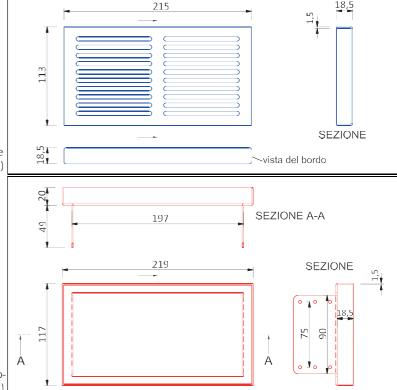
GRIGLIA INOX (parte del controtelaio fissabile con viti )
