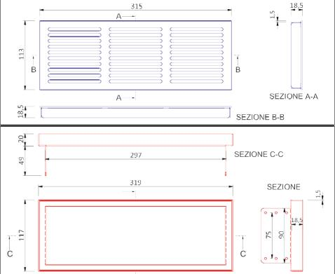
GRIGLIA INOX (parte del controtelaio fissabile con viti )
