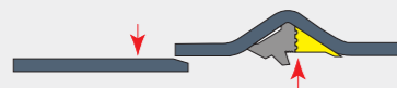
Les 2 tolérances que l'on retrouve dans un anneau avec le système Power Lock®
