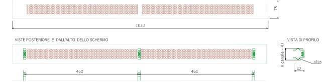
Il diffusore <u>non</u> ha a corredo la cornice; per cui esso va installato direttamente sul plenum-adattatore (tipo VMAD10X55--) oppure direttamente a canale.
