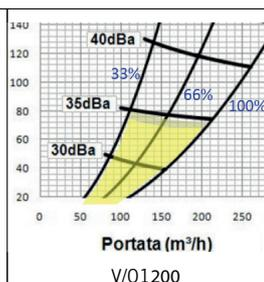
Zone evidenziate in giallo: portate massime consigliate in base al grado di apertura delle valvole (25%, 50%, 75% e massima apertura)
