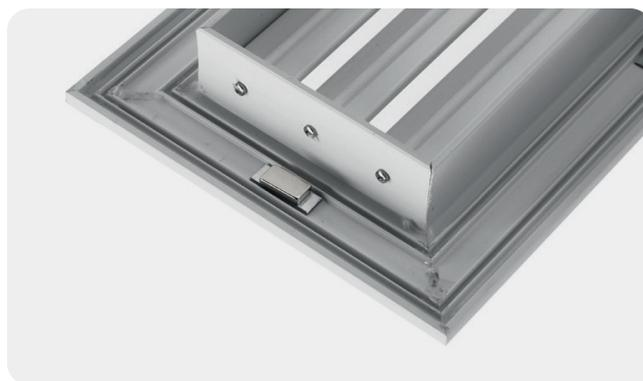
Nel sistema a magneti cod. M/01 è necessario associare alla griglia/bocchetta un controtelaio (ad esempio un controtelaio FITT Agix® della serie -C/01) oppure un tratto di canale zincato terminante con bordino oppure ancora una serie di angolari a L in lamiera zincata fissabili al plenum/adattatore (staffette, a cura del cliente) in numero pari al numero di magneti.
