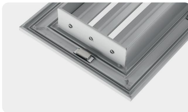
Nel sistema a magneti cod. M/01 è necessario associare alla griglia/bocchetta un controtelaio (ad esempio un controtelaio AIRPLAST della serie C/01) oppure un tratto di canale zincato terminante con bordino oppure ancora una serie di angolari a L in lamiera zincata fissabili al plenum/adattatore (staffette, a cura del cliente) in numero pari al numero di magneti.
