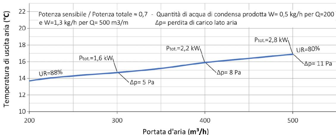
Grafico della batteria a 3 ranghi in parz. raffresc. con acqua a temp.  $T_{ing}-T_{usc.}=18-20^{\circ}C$ ; portata acqua =500 l/h
