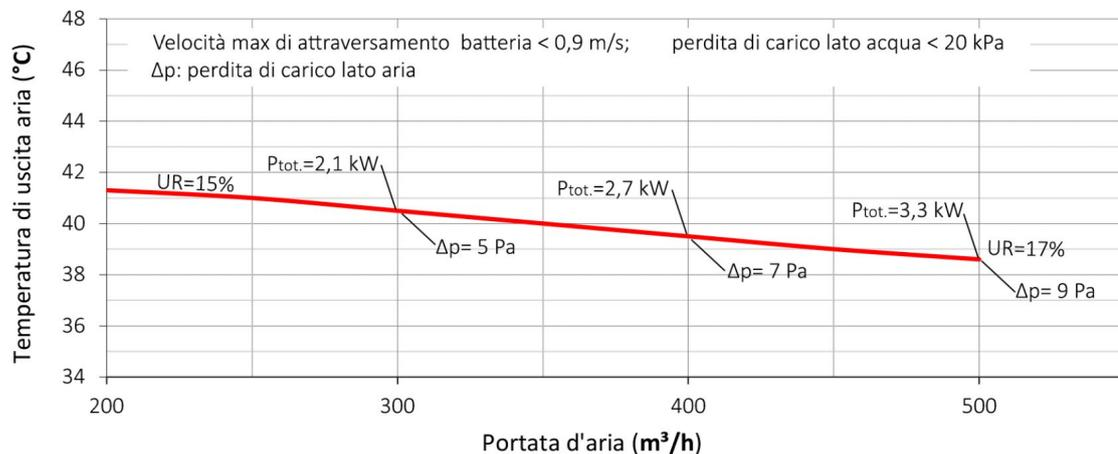
ESEMPIO DI ELABORATO DAL SOFTWARE DI CALCOLO DELLE BATTERIE
