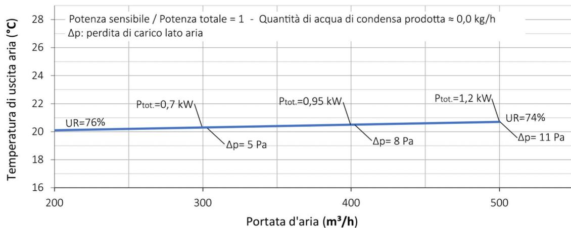
Grafico della batteria a 3 ranghi in riscaldamento con acqua a temp.  $T_{ing}-T_{usc.}=45-40^{\circ}C$ ; portata acqua =500 l/h
