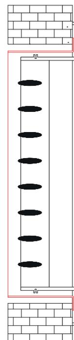
ESEMPIO DI CODIFICA DI UN CONTROTELAIO PER UNA BOCCHETTA DI MISURA FORO B x H = 200 x 100 mm:
