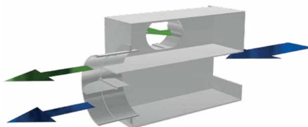
Sezione plenum in funzione VMC + CLIMA
