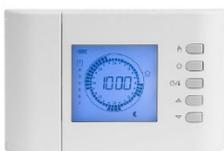
L'umidostato digitale è un comando remoto che va collegato alle morsettiere del quadro elettrico al posto dell'umidostato standard, già installato di serie sui deumidificatori. Si consiglia di installare un interruttore ON-OFF in serie all'umidostato. Quanto sopra vale identicamente per il cronotermostato.
