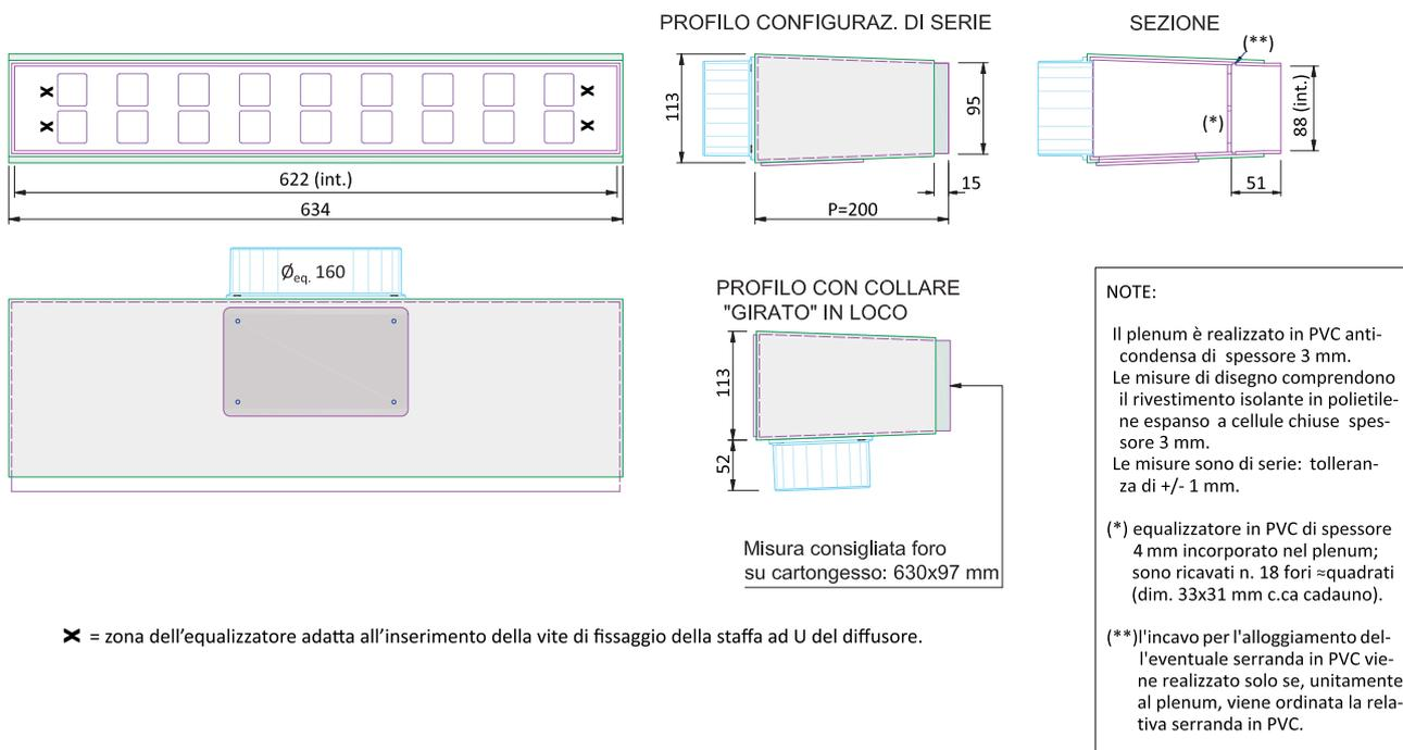
Plenum in PVC per diffusore lineare a 2 feritoie  $L_{nominale}$  =800 mm con attacco REVERSIBILE  $\varnothing 160$  mm
