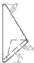
Disegno in sezione del "coperchio" o "corpo" della griglia, da fissare a incastro sulla base
