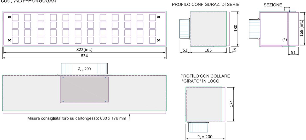
X = zona dell'equalizzatore adatta all'inserimento della vite di fissaggio della staffa ad U del diffusore.
