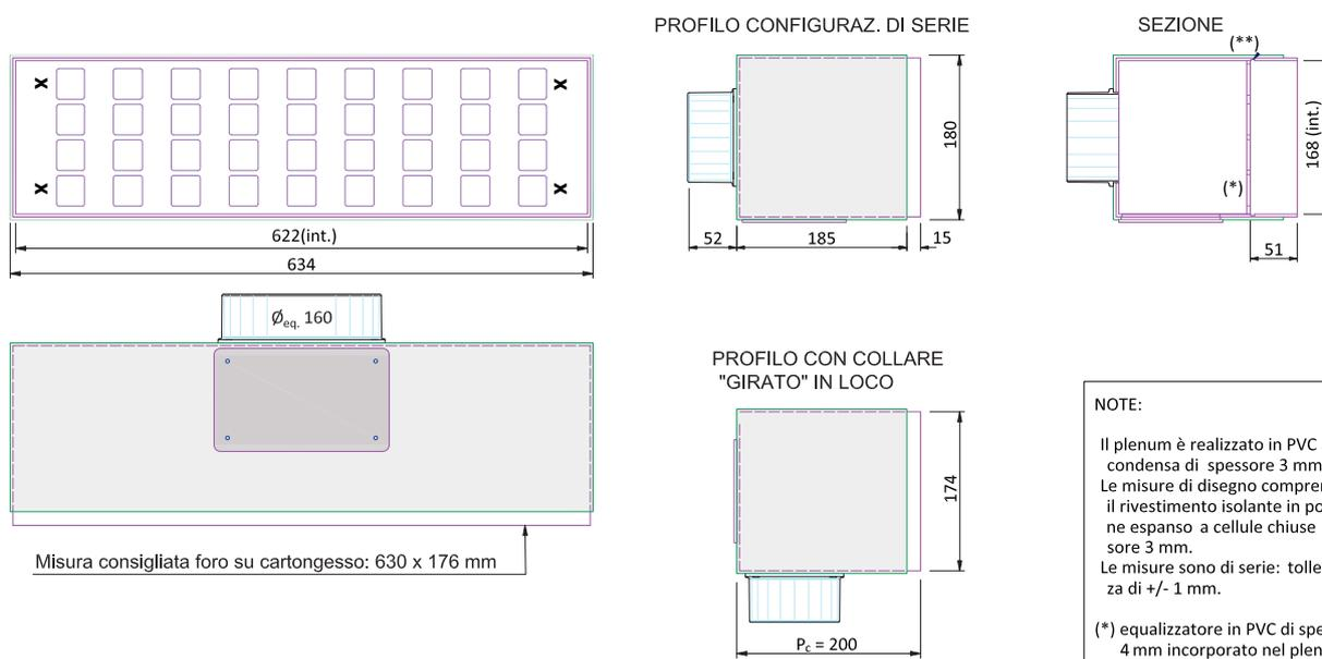
X = zona dell'equalizzatore adatta all'inserimento della vite di fissaggio della staffa ad U del diffusore.
