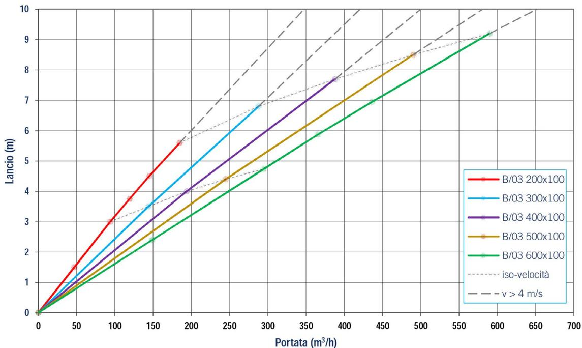
Lancio (in mt, calcolato con velocità terminale  $v_t = 0,25$  m/s) delle bocchette B/03 di misura nominale H=150 mm
