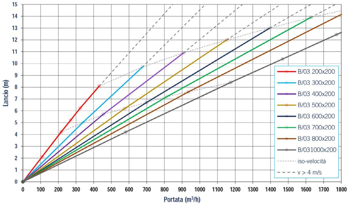
Lancio (in mt, calcolato con velocità terminale  $v_t = 0,25$  m/s) delle bocchette B/03 di misura nominale H=300 mm
