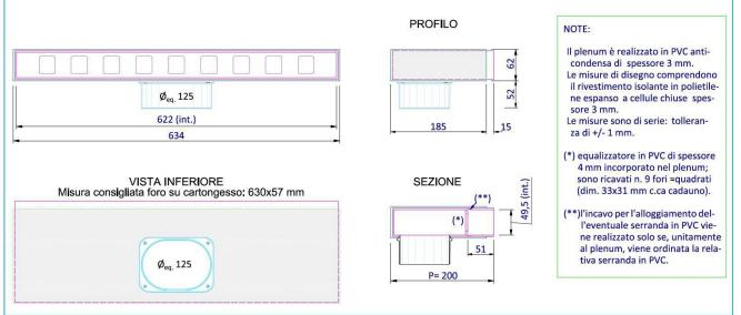
Plenum in PVC per diffusore lineare ad 1 feritoia  $L_{nom.}$  800 mm con attacco LATERALE Ø125 mm cod. ADF-P04800X1L12
